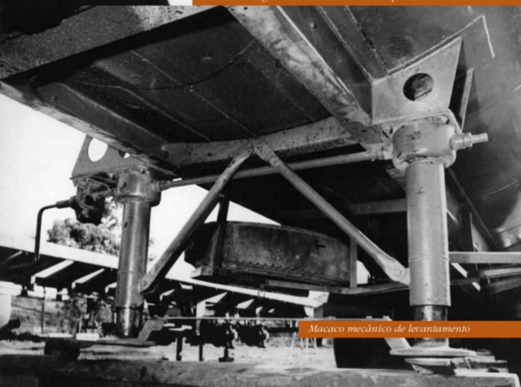
*Macaco mecânico de levantamento*
